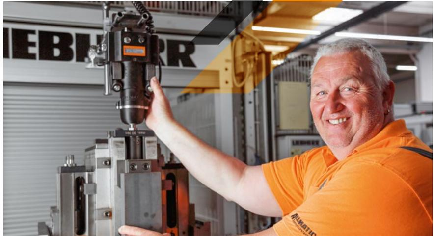
Spannsysteme zählen zu den wichtigsten Maschinenelementen von Bearbeitungszentren. Denn nur wenn Werkstücke sicher sitzen und die Bearbeitung unterstützen, kann eine CNC-Maschine schnell und effizient arbeiten. Für die Wirtschaftlichkeit der kostenintensiven Werkzeugmaschinen ist das schnelle und zuverlässige Spannen von Werkstücken essentiell. Dies geschieht in der Regel mithilfe eines Drehmomentschlüssels oder einer Handkurbel direkt in der Maschine oder außerhalb an einem Rüstplatz.
